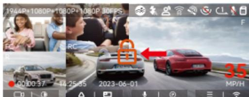
自動で、車が強い衝撃/振動を受けると、Gセンサーにより本機はそのときの映像を自動的にロックしてイベントのフォルダに保存します。G-Sensor感度の設定によって、検知できる衝撃の感度には違いがあります。G-Sensor感度の設定によって、検知できる衝撃の感度には違いがあります。
