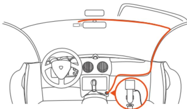
Cuando guarde el cable de carga del automóvil o el cable de la lente trasera, puede usar la hebilla del cable para fijarlo. Después de pegar la hebilla de alambre en la posición adecuada, asegure el cable dentro de la hebilla.
