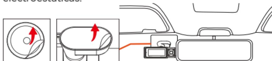
**Nota:** Para aumentar la firmeza del soporte, se puede usar un promotor de adherencia del soporte en la posición de instalación antes de instalar el soporte.
