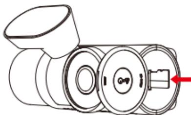
Después de insertar la tarjeta de memoria, si aparece en pantalla “Error de tarjeta SD” (tenga en cuenta que la dashcam no puede grabar así), por favor diríjase al menú de “Configuración del sistema” y seleccione “Formatear” y confirme el OK en “Formatear tarjeta de memoria” hasta que reciba el mensaje de “Formateo satisfactorio”.
