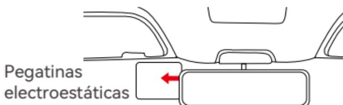
**Nota:** Hay dos pegatinas electroestáticas con láminas protectoras. Por favor remueva la lámina protectora Nro. 1 y pegue la pegatina electroestática en el parabrisas, y entonces quite la lámina protectora Nro. 2. Remueva la cinta 3M de la montura, entonces fije la montura y la cámara en las pegatinas electroestáticas.
