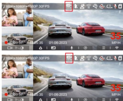
Wenn nach 5 Minuten Aufnahme keine Bewegung erkannt wird, erscheint ein Symbol in der Mitte des Bildschirms. Die Auflösung aller aktuellen Videos wird für die Aufnahme automatisch auf **720P 15FPS** oder **1080P 15FPS** umgeschaltet, und die Aufnahmedauer wird entsprechend der aktuell eingestellten Daueraufnahmedauer bestimmt. Wenn die Kamera vibriert oder bewegt wird, wird sie automatisch den Modus verlassen, 5 Minuten warten und wieder eintreten.
